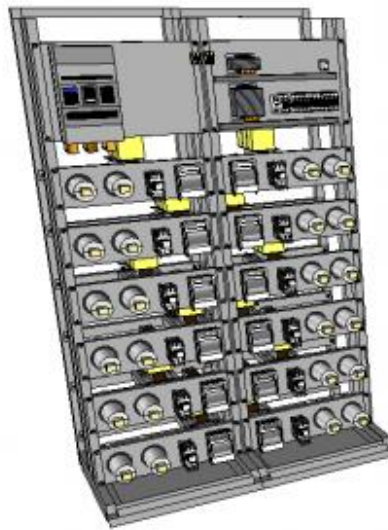
Ilustración 15- Banco de capacitores
